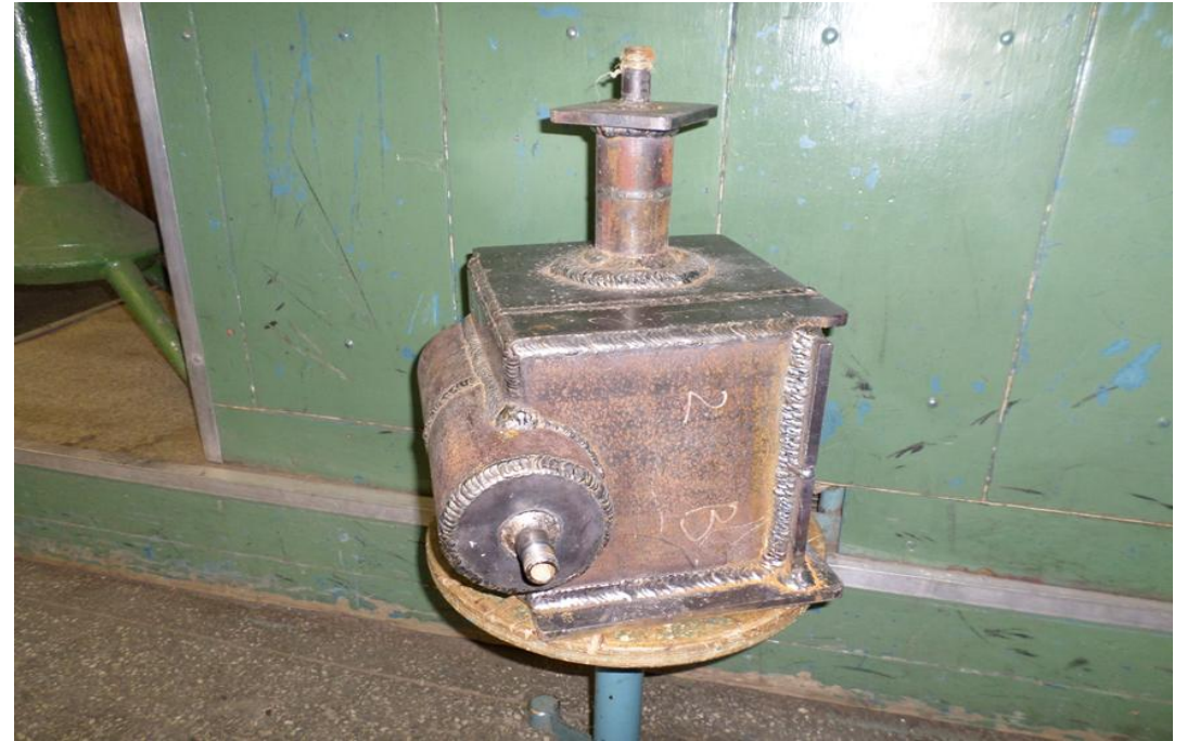
Компетенция: «Сварочные технологии» Сосуд, работающий под давлением
